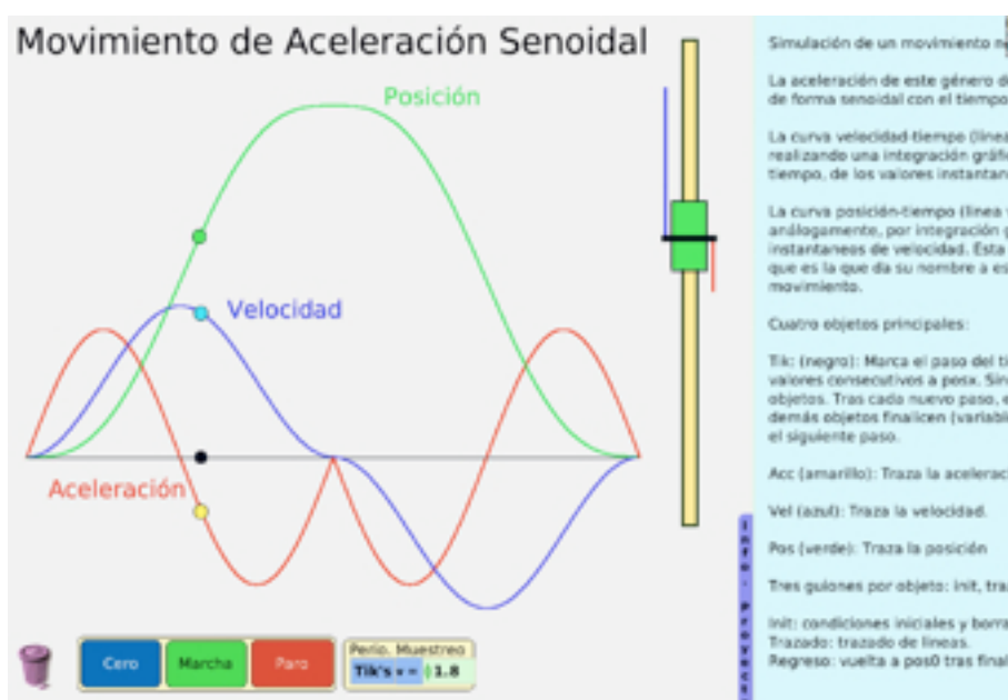
Figura-1 Simulación de un movimiento lineal de aceleración senoidal
