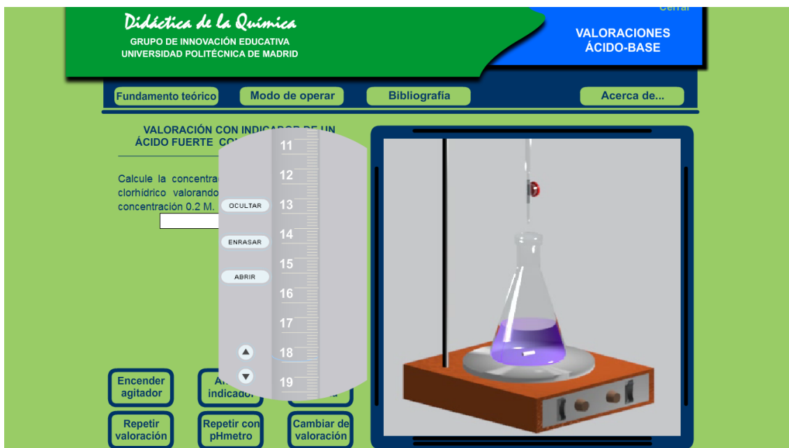
Figura 31: Applet UPM. Quan s'ha produït la reacció completa, l'indicador canvia de color.
