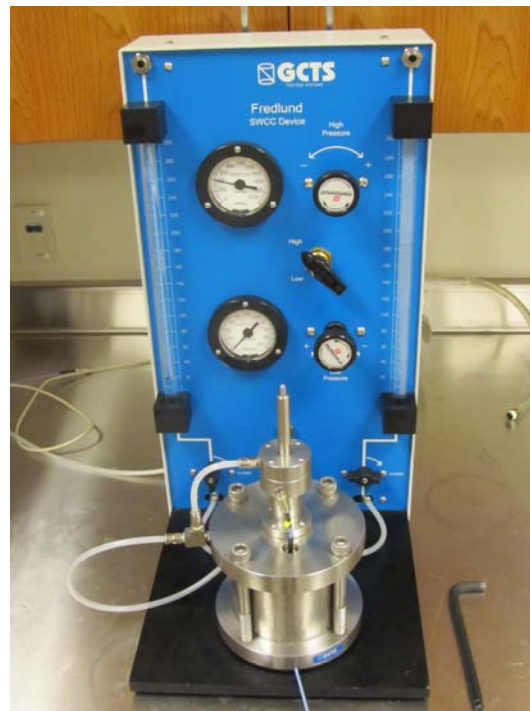
Fig. 3.24.-Ensayo en marcha de Curva característica en "Tempe Pressure Cell "
