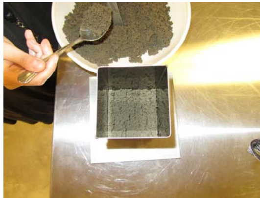
Fig. 3.6.- Colocación de muestra en molde.
