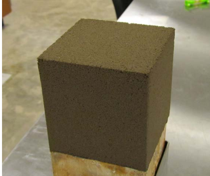
Fig. 3.41.- Muestra de suelo SC-SP después de compactar.
