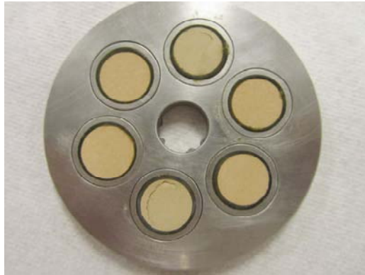
Fig.3.20.- Piedras porosas de 5 bares utilizadas en “Tempe Pressure Cell”.
