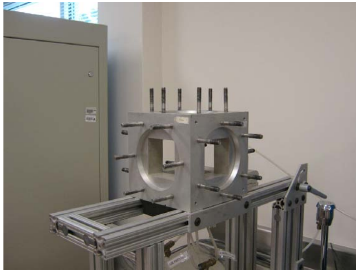
Fig. 3.28.- Estructura soportante de muestra cubica.
