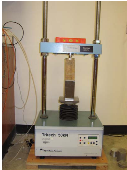
Fig. 3.9.- Compactación estática en marco triaxial.
