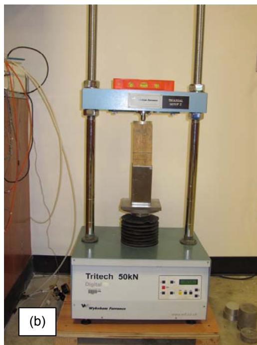
Fig. 3.40.- Marco de carga triaxial. (a) Muestra de suelo sin compactar. (b) Compactación a razón de 1mm/min.
