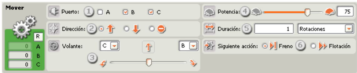
Fig.4 Ventana de configuración bloque motor
