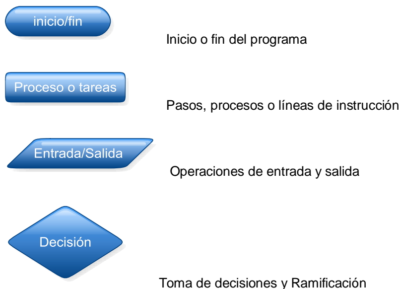
Fig. 9 Definición de los bloques del diagrama de flujo
