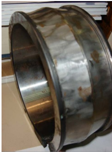
Figura 7: Pistas internas deformadas de un rodamiento del rotor
