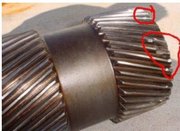
Figura 6: Pérdida de material en los dientes de un engranaje dañado
