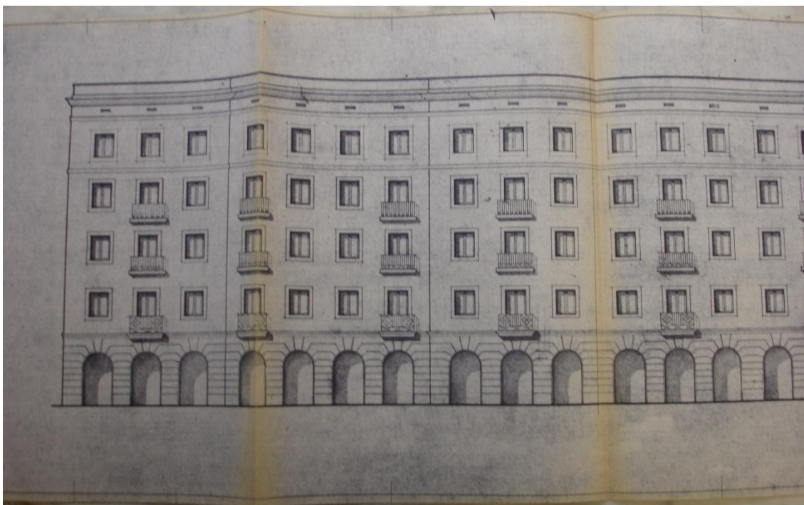
Bonsuccés (1958) edifici amb estructura de murs de fàbrica ceràmica amb forjats carregant sobre la façana. Superfície opaca similar a la superfície d'obertura amb finestres estretes alineades en altura
