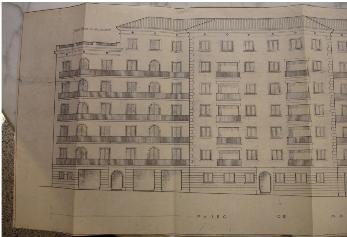
Torre Llobeta (1946) edifici amb estructura de murs de fàbrica ceràmica amb forjats carregant sobre la façana.
