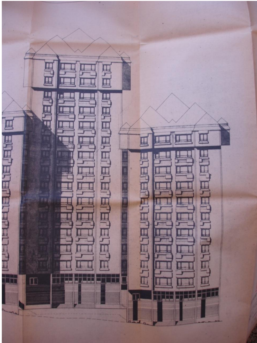
Canyelles Bloc A (1975) edificis molt alts realitzats amb estructura d'encofrat túnel i façana convencional amb full exterior de maó ceràmic, cambra d'aire amb aïllament i envà interior amb més obertura que paret opaca.
