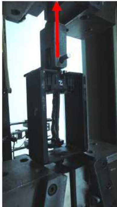
Imagen 2: Disposición para ensayo de tracción
