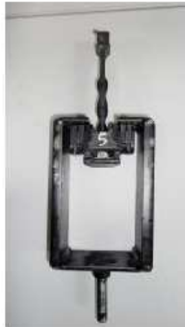
Imagen 1: Útil con un retenedor instalado
