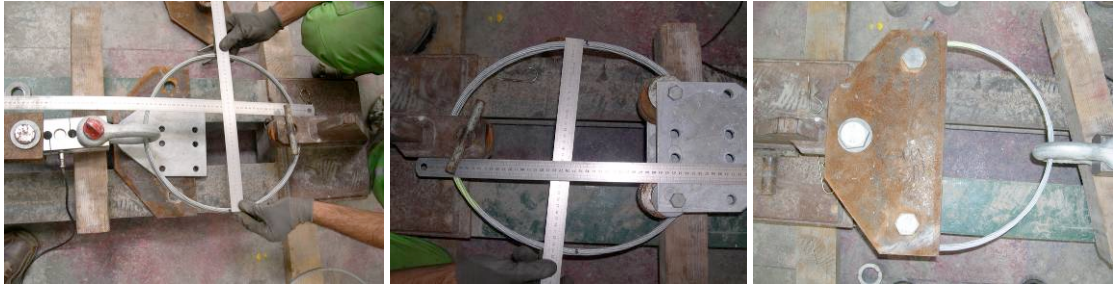
Photo 6 : Configuration pour la réalisation des essais sur deux, trois et quatre points.
