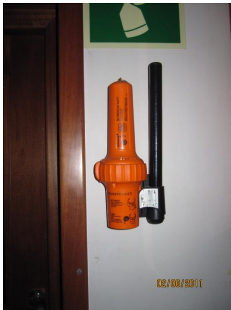
Transponedor radar al pont de navegació.
