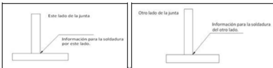
Figura 3.3. Indicación del lado a realizar la soldadura.
