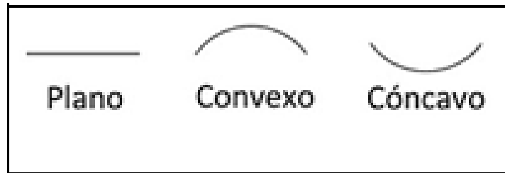
Figura 3.9. Indicación del contorno de la soldadura.
