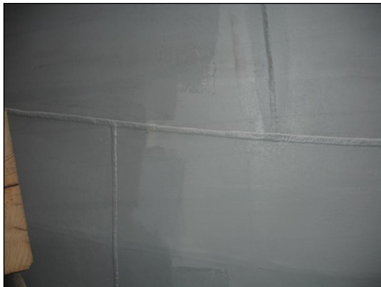
Figura 6.53. . Chapa del forro exterior de un buque de acero soldados por el proceso SAW.
