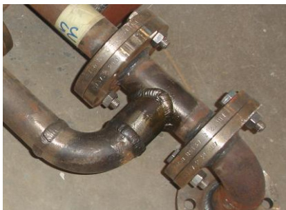
Figura 6.2.5 Unión en ángulo de tubería.
