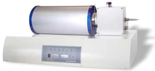
Figura 6.3. Equipo para la medida simultánea de conductividad eléctrica y coeficiente Seebeck.
