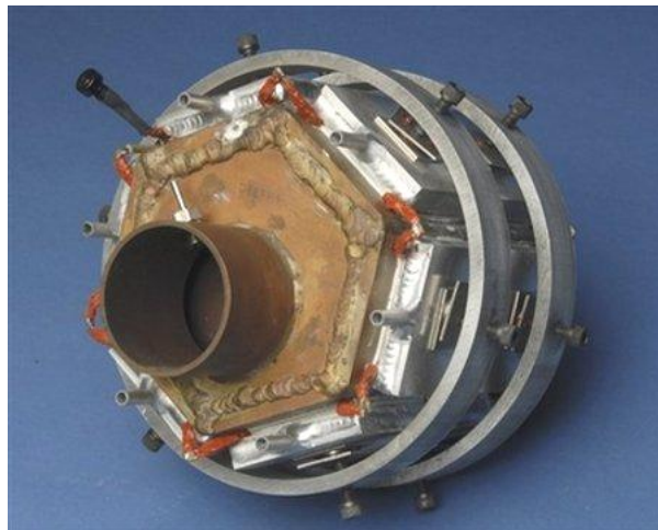
Figura 4.4. Prototipo de generador termoeléctrico de BMW, con el conducto central para los gases de escape y los pequeños conductos periféricos para refrigerar el lado frío. Premio ÖkoGlobe 2008.
