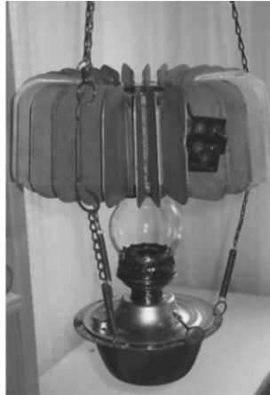
Figura 4.3. Generador termoeléctrico a queroseno para alimentar equipos de radio.
