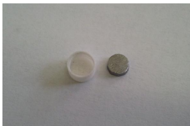
Figura 7.10. Crisol de alúmina para TGA/DSC (izquierda) y muestra (derecha).
