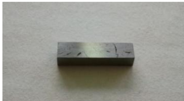
Figura 7.9. Muestra prismática para determinación del coeficiente Seebeck y la resistividad eléctrica.
