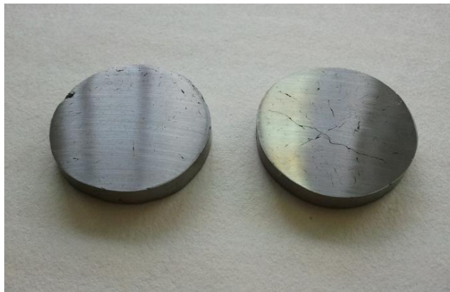
Figura 7.7. Probetas gemelas para la determinación de la conductividad térmica.
