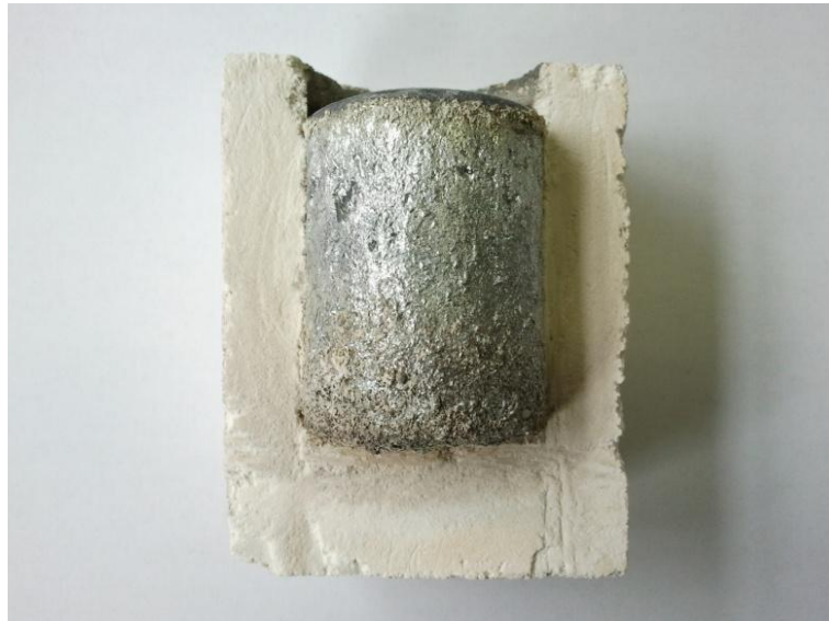
Figura 7.5. Aspecto del lingote durante la extracción del molde.
