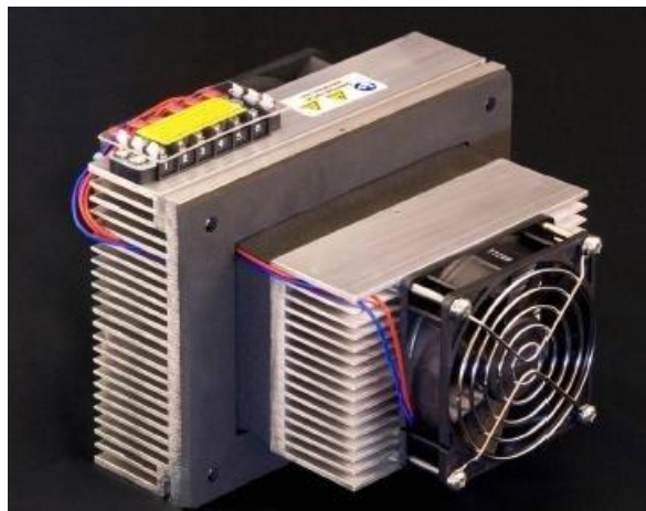
Figura 4.7. Refrigerador Peltier equipado con disipadores de aletas para el intercambio de calor y ventiladores. El módulo termoeléctrico se encuentra entre los dos disipadores.
