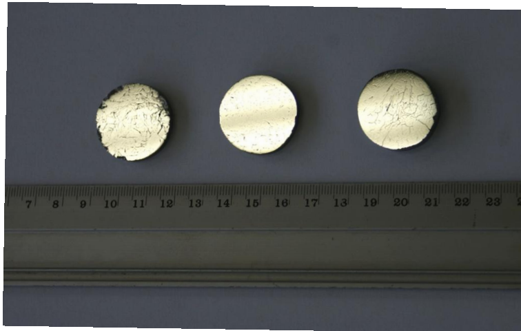
Figura 7.8. Muestras pulidas para observación microscópica.
