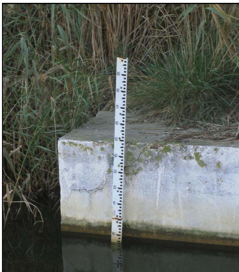
Fig.8. Limnimetre instal·lat a l'embarcador de la llacuna de la Ricarda (mesura manual del nivell).
