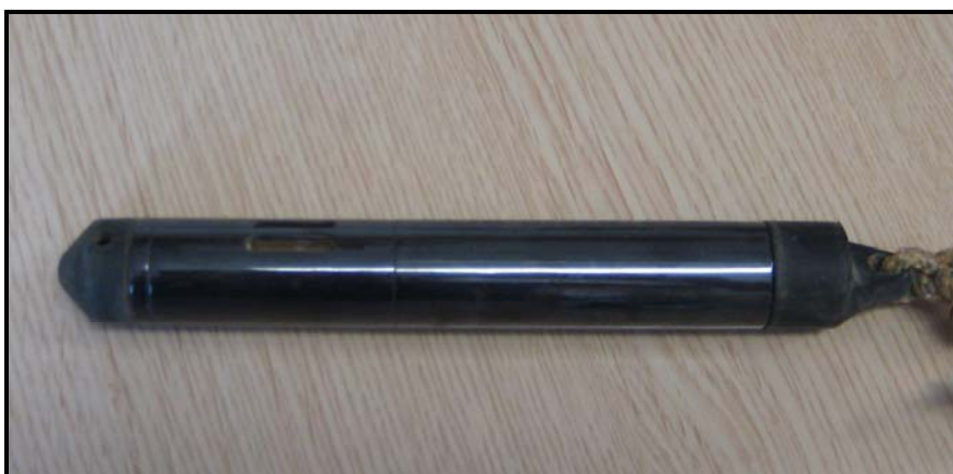
Fig.6. CTD (mesura conductivitat, temperatura i pressió)
