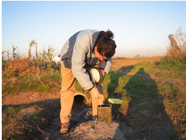
Fig.34. Mesura in-situ del nivell piezomètric.
