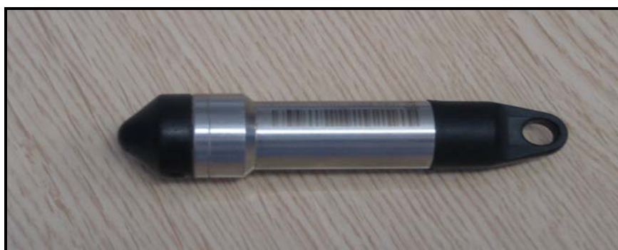
Fig.7. TD (mesura temperatura i pressió)
