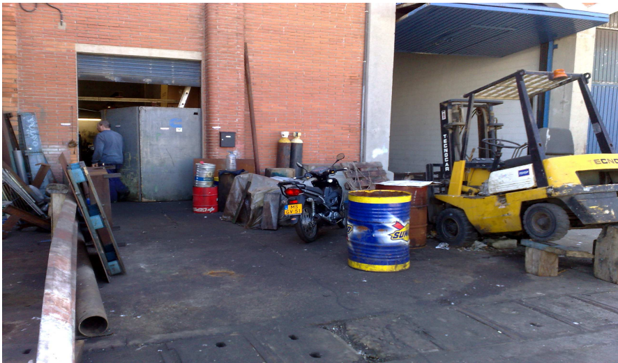
Foto 13. Se puede comprobar cómo la máquina (carretilla mecánica) se encuentra mal estacionada, rodeada de materiales innecesarios. Está visiblemente sucia, teniendo cerca bidones de aceite y bombonas de soldadura.
