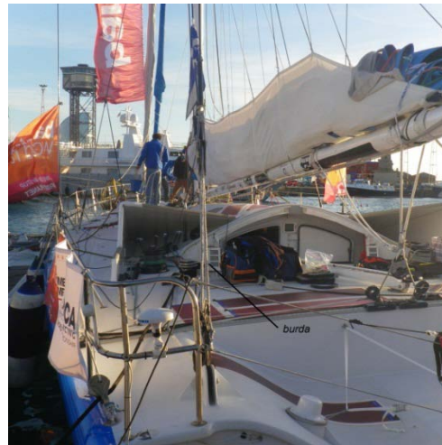
Il·lustració 31- Detall de les burdes d'un Imoca 60
