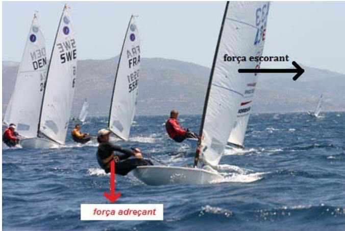
Il·lustració 64-Representació de la força escorant i adreçant d'una embarcació de la classe europa navegant en cenyida
