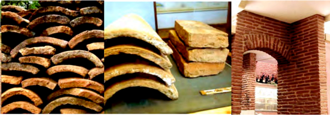
Figura 24. Materiales: Tejas y Ladrillos de Barro
