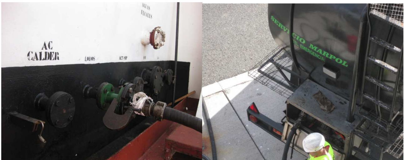
figura 56. Descarga de lodos
