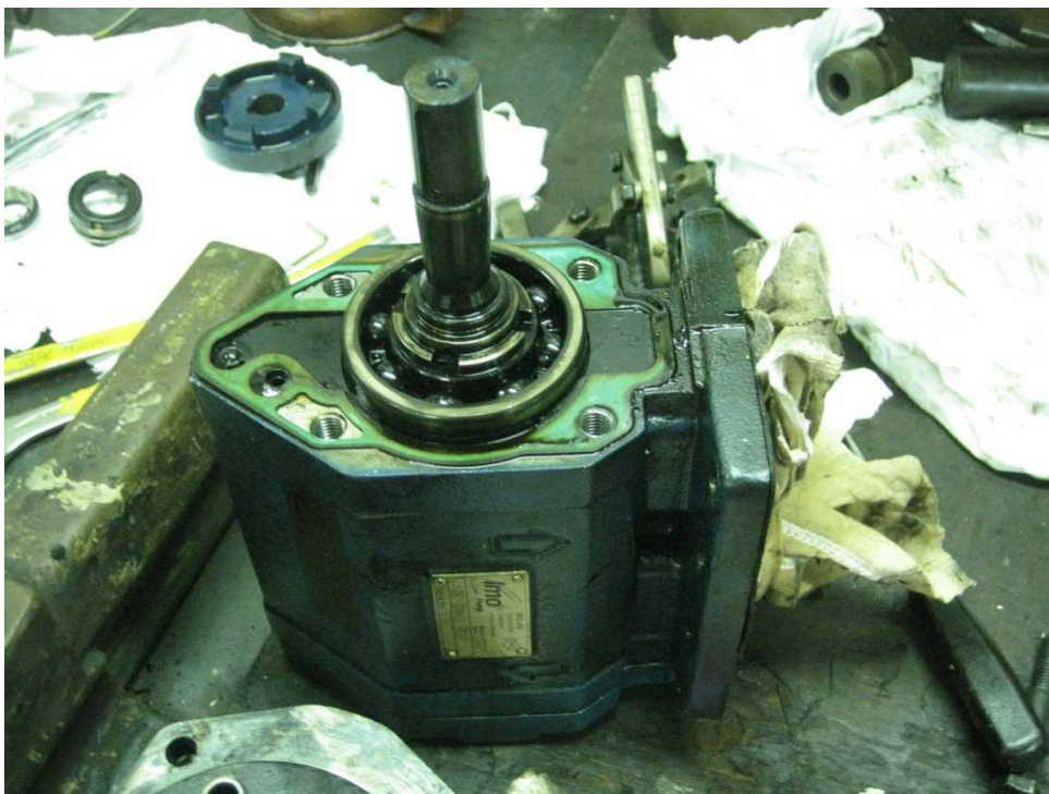
figura 24. Bomba de tornillo alimentación combustible
