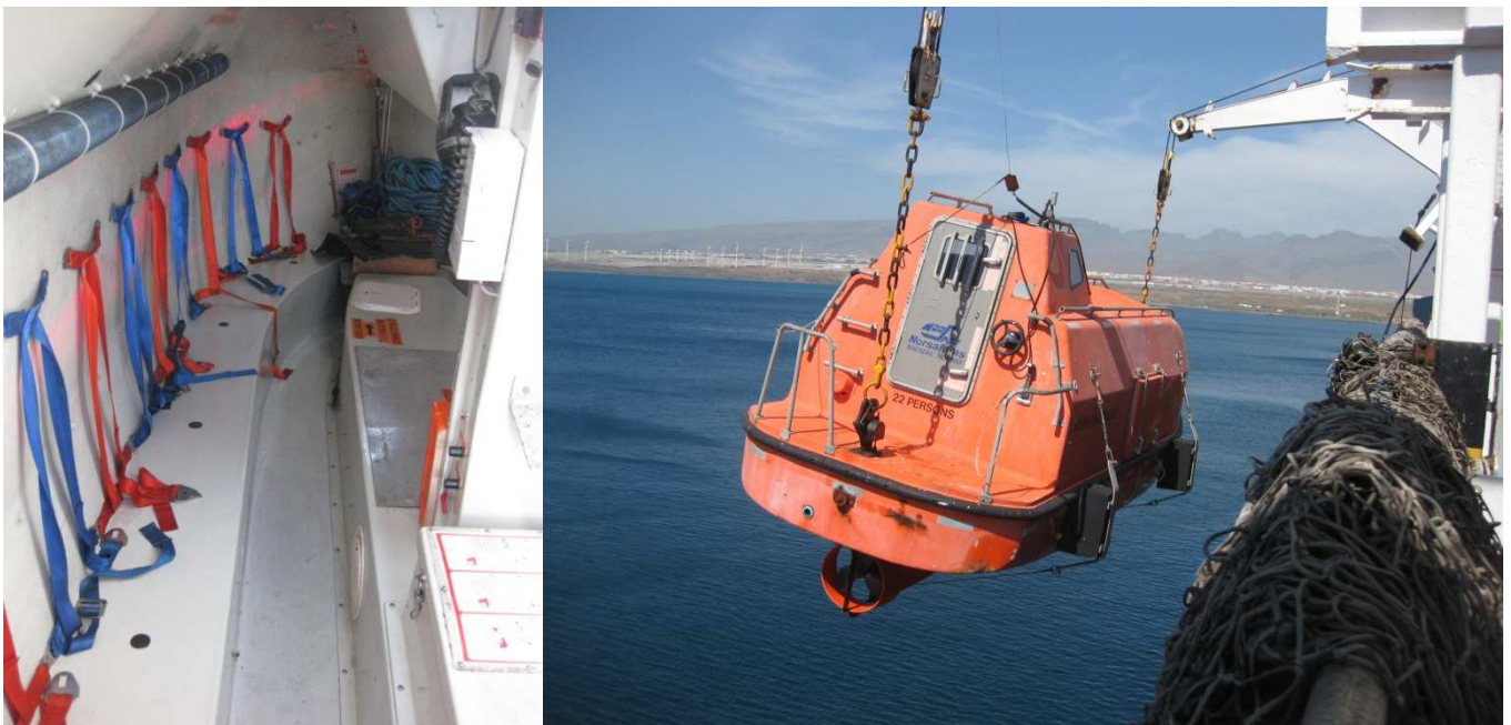
figura 51 y 52. Interior del bote de rescate/ Arriado del bote
