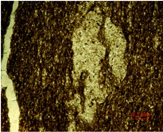
Figura 9.3.4.1. Matriu argilosa orientada + nòduls carbonatats + fractura de descompressió. Nicols encreuats.
