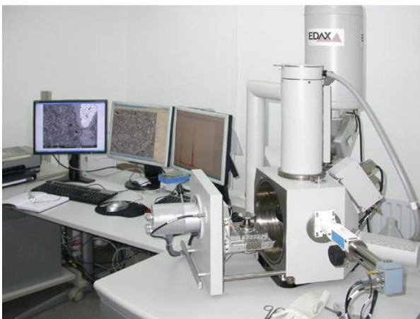
Figura 3.7.2.8. Microscopi d'escombrat electrònic (SEM) model ESEM Quanta 200 FEI, XTE 325/D8395 dels Serveis Científico-Tècnics de la Universitat de Barcelona. La cambra de la mostra és oberta. Disposa de tres monitors. Un d'ells per a la gestió dels arxius generats, l'altre per al software de control xT i per a la visualització de les imatges i un tercer monitor per al espectres d'EDS.
