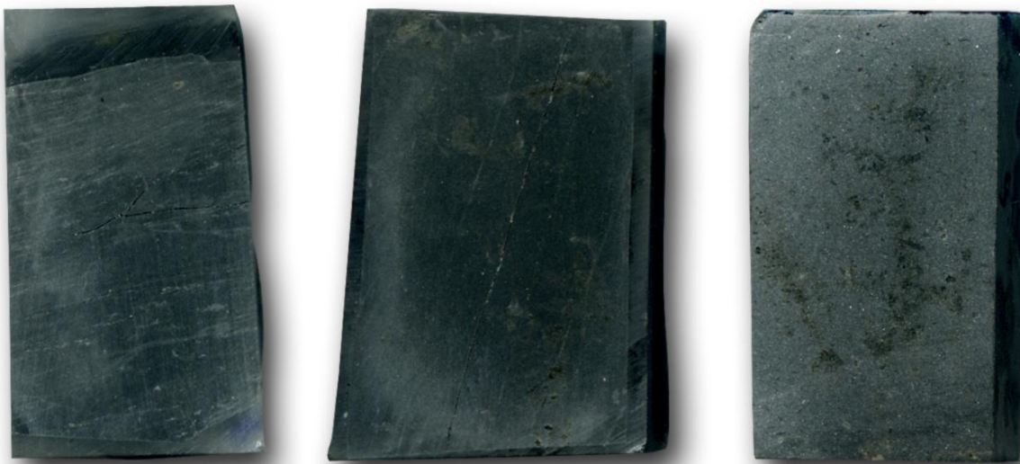
Figura 4.8.1.1. Rèpliques de les mostres OM-2, OM-10 i OM-18, corresponents a una argil·lita, una limolita i un gres quarsític, respectivament.
