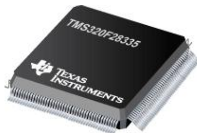
Fig. 7.10. DSP de Texas Instruments modelo TMS320F28335.
