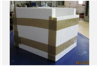
Preparación del encofrado con poliestireno expandido.
