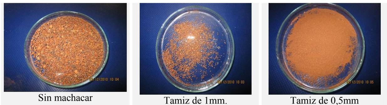
**Fig.6:** Los tres tipos de muestras de GR42 que se utilizan en el ensayo.
