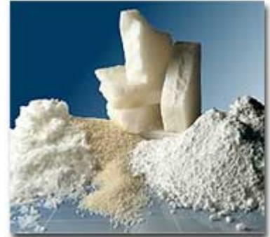
La capacidad calorífica específica de parafinas de calor latente es de 2,1 kJ/(kg × K). Su entalpía de fusión se encuentra entre 120 y 160 kJ/kg, lo cual es muy alto para los materiales orgánicos. La combinación de estos dos valores provoca una densidad de almacenamiento de energía excelente. En consecuencia, las parafinas de calor latente ofrecen de cuatro a cinco veces mayor capacidad de calor por volumen o masa, que el agua.
