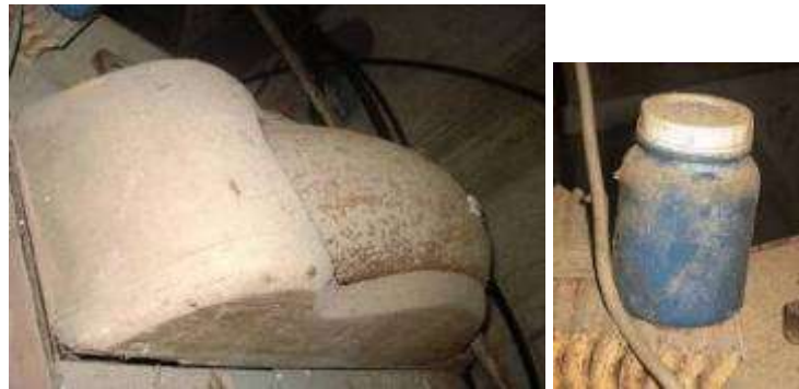
Figura 5.65 Mola manual per acaba el cuir en ant. Es fa girar la mola mitjançant pedals. El pot de pols es s'ha trobat al costat de la mola. El tap és dispensador de la pols per tal que quedi ben escampat a la superfície de la mola
