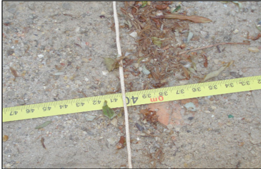
Fig. 61, Colocación de la lienza sobre un lado del cuadrilátero materializado por la cinta métrica
