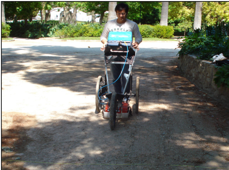
Fig. 62, Paso del georradar por el camino marcado por la lienza.
