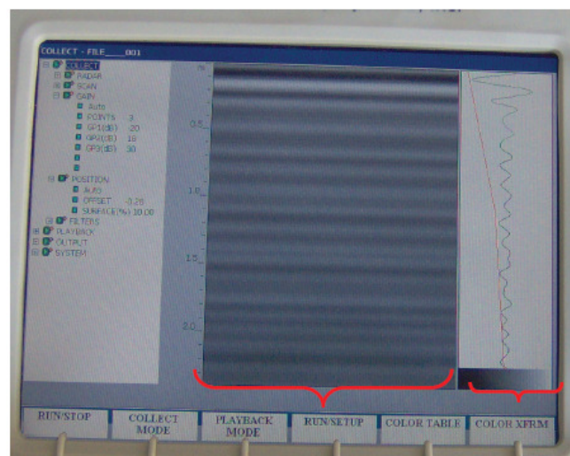
Fig. 33, Vista del programa. La primera zona marcada es una visualización de amplitudes, la segunda zona remarcada es el osciloscopio (la línea roja indica las ganancias).
