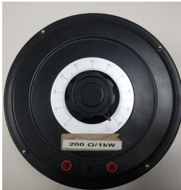
**Figura 6.2.2.-** Carga para las pruebas de la implementación de la fase.
