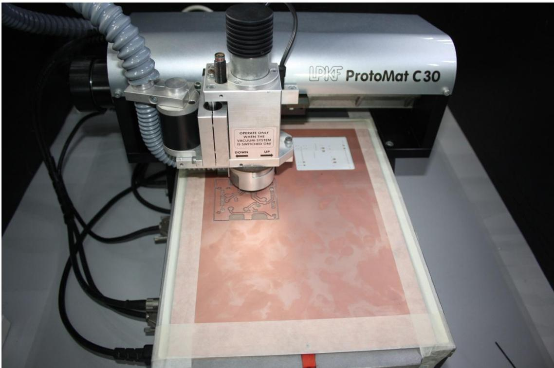
**Figura 5.1.3.1.1-** Impresión del circuito mediante LPKF.
