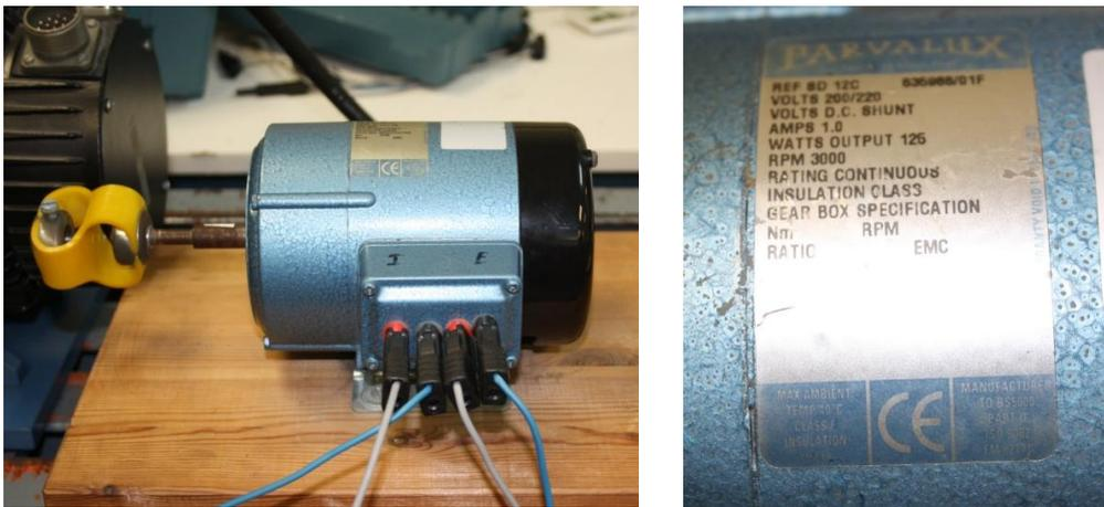
**Figura 6.3.1-** Imágenes reales del motor de corriente continua utilizado para las pruebas de laboratorio.
