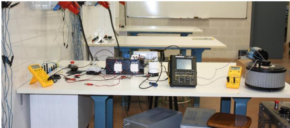
Figura 6.2.3.1- Imagen real al laboratorio del montaje de la instalación con una resistencia como carga.
