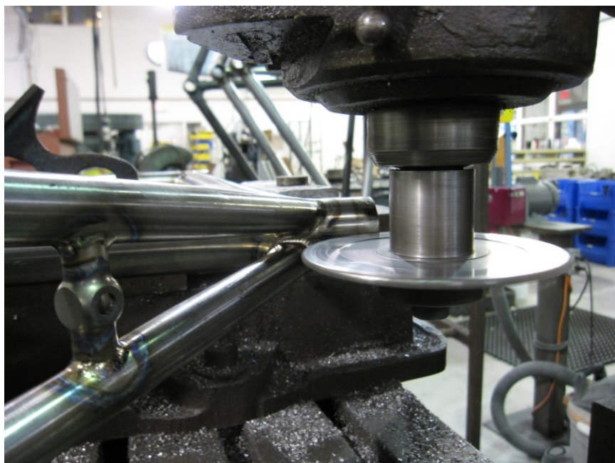
Fig 73. Procés de ranurat del tub del sallent.
