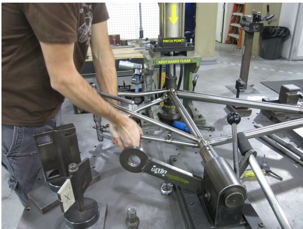
Fig 70. Un operari fent un treball de realineament de les punteres a la taula d'alineació.
