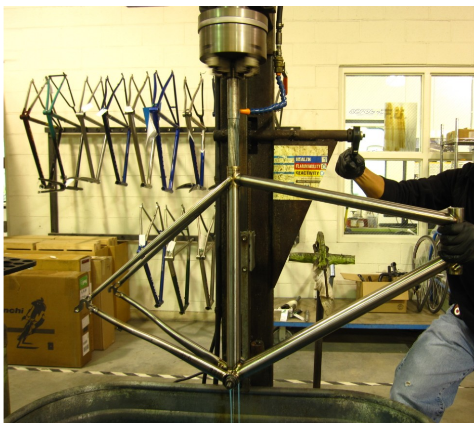
Fig 74. Operació d'escariat del tub del sallent.
