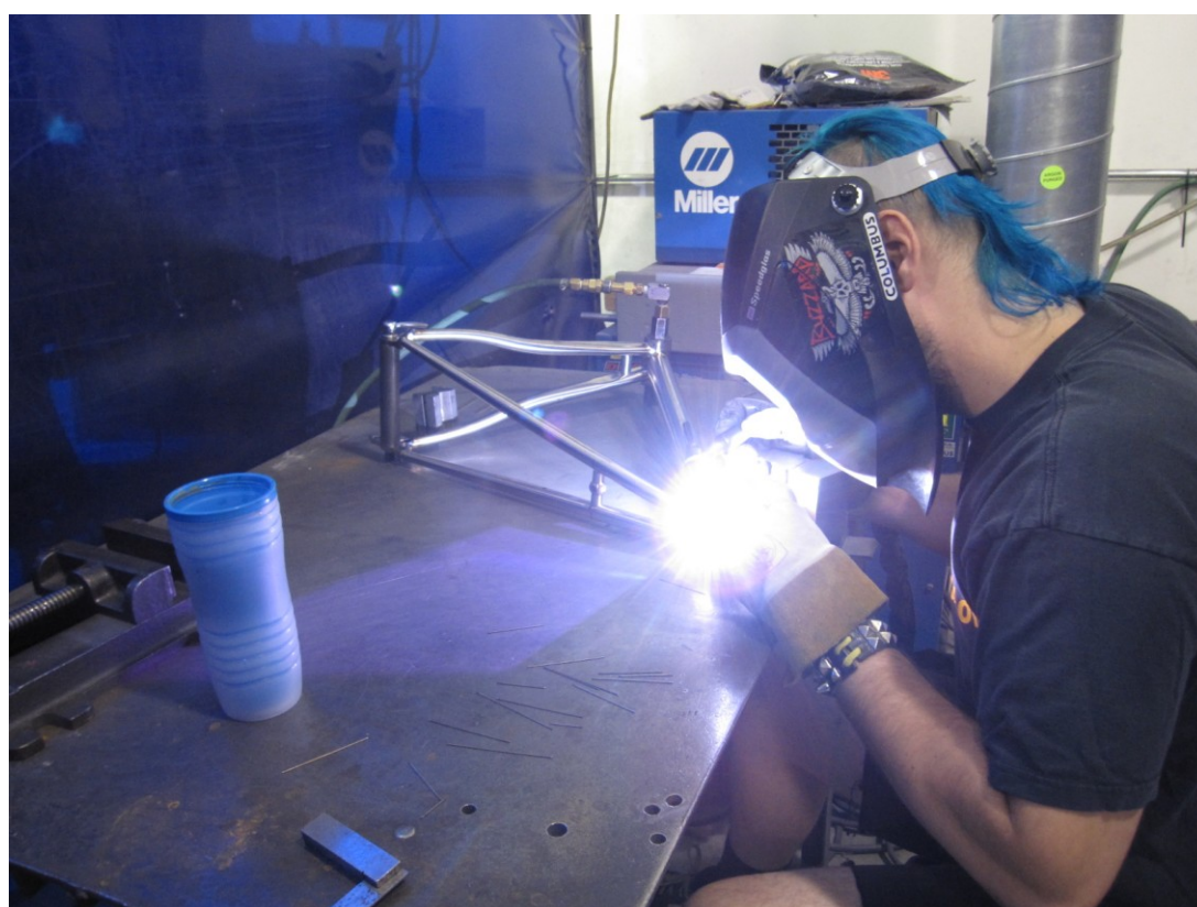
Fig 71. Procés de soldadura TIG d'un basculant.
