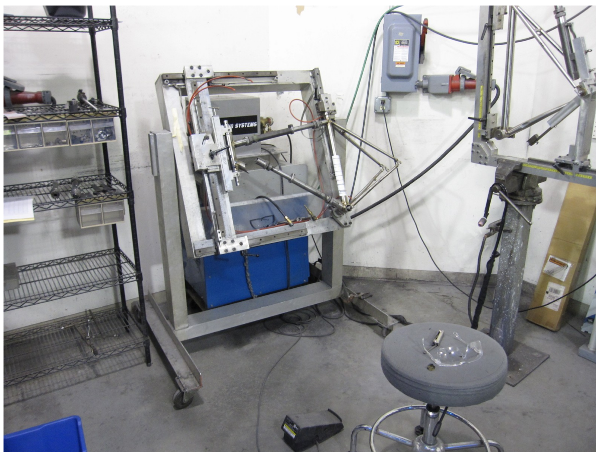
Fig 69. Lloc de treball per a la soldadura de bicicletes. Al centre de l'imatge es troba la bancada per a puntejar triangles davanters. A la dreta s'hi troba una bancada per a puntejar basculants.
