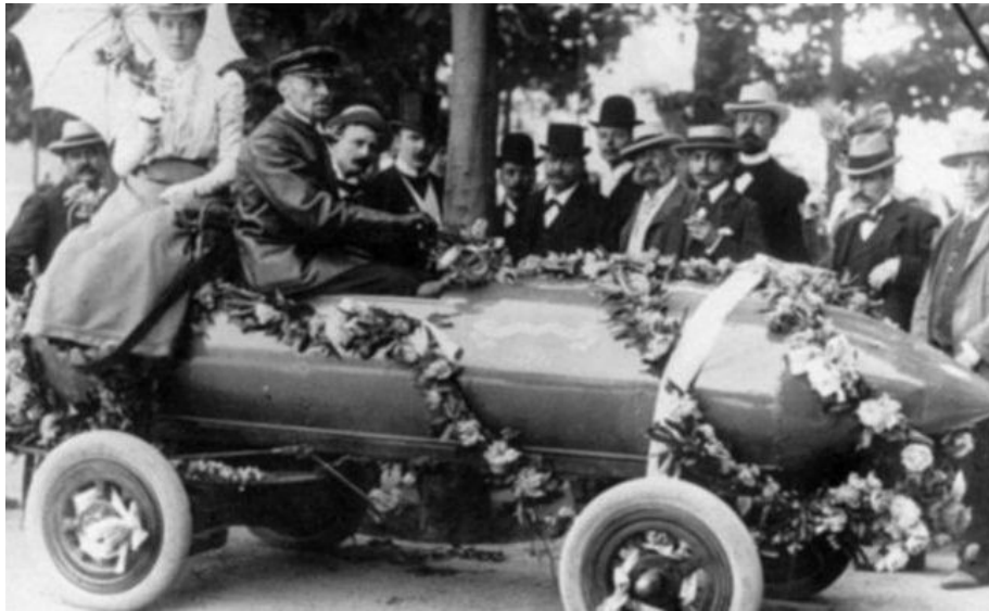
Figura 9. La Jamais Contente, primer vehículo en superar la barrera de los 100 km/h el 29 de Abril de 1899. Era un vehículo eléctrico.
