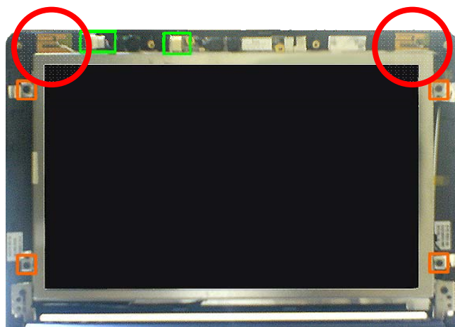
Fig. 3.1 Disposició de les antenes Wi-Fi en un ordinador portàtil Acer Aspire One [59]
