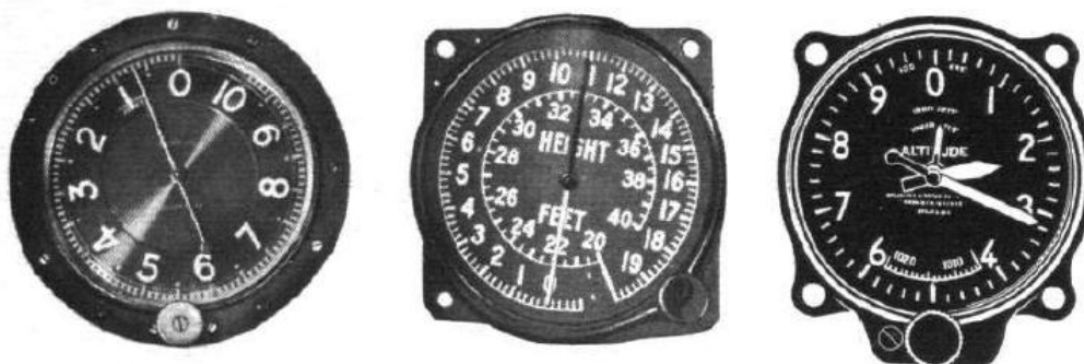
Fig. 2.6 Tres exemples de displays d'altímetres. D'esquerra a dreta, any 1913, 1930 i altímetre analògic actual. [7]
