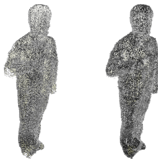
Figura 6.14: Comparació reconstrucció de superfície obtinguda amb els mètodes seqüencial i paral·lel. La reconstrucció de l'esquerra correspon al seqüencial, a la dreta el paral·lel
