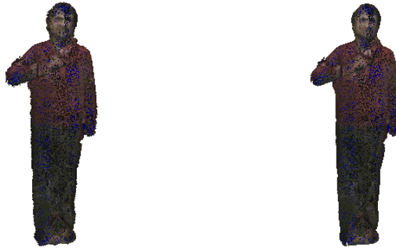
Figura 6.16: Acoloriment dels punts de superfície a partir d'una reconstrucció seqüencial. A l'esquerra versió sense suavitzat de superfície, a la dreta reconstrucció suavitzada
