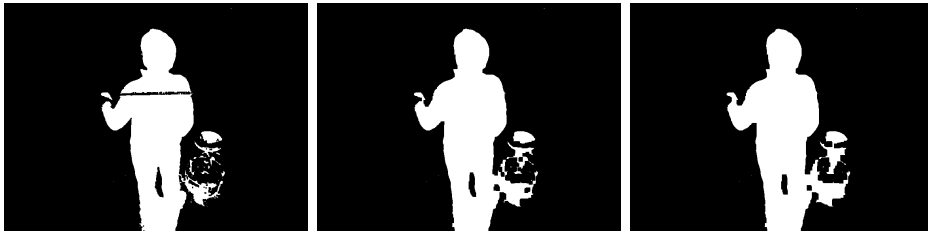
Figura 4.7: Resultat d'aplicar tancaments de dimensió creixent
