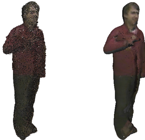
Figura 6.18: Resultat obtingut amb el mètode seqüencial dinàmic amb cerca a tota la sala. A l'esquerra sense post-processament, a la dreta amb l'estimació de normals i el suavitzat posterior
