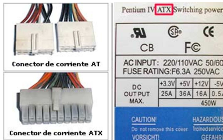
Figura 9: Conectores de corriente fuentes de alimentación
