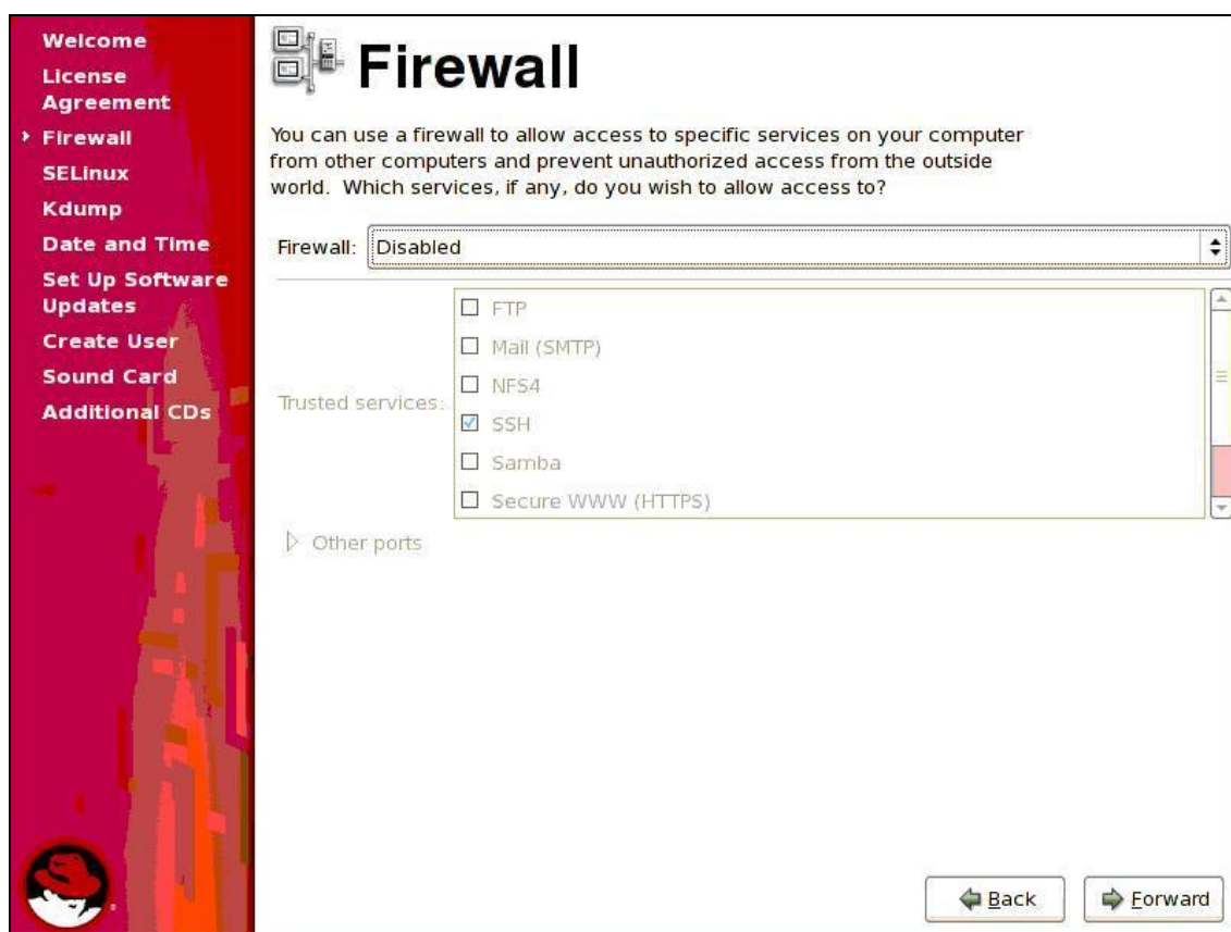
Fig. A.20 Deshabilitar Cortafuegos
