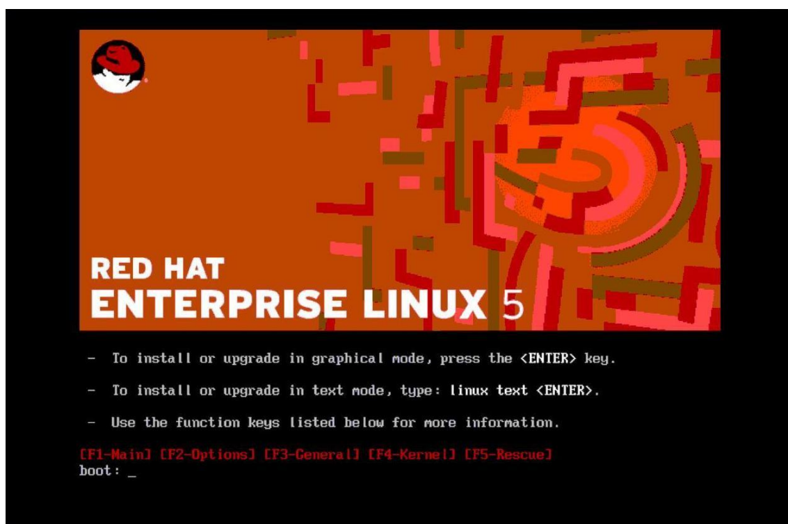
Fig. A.1 Pantalla de inicial para la selección del tipo de instalación
