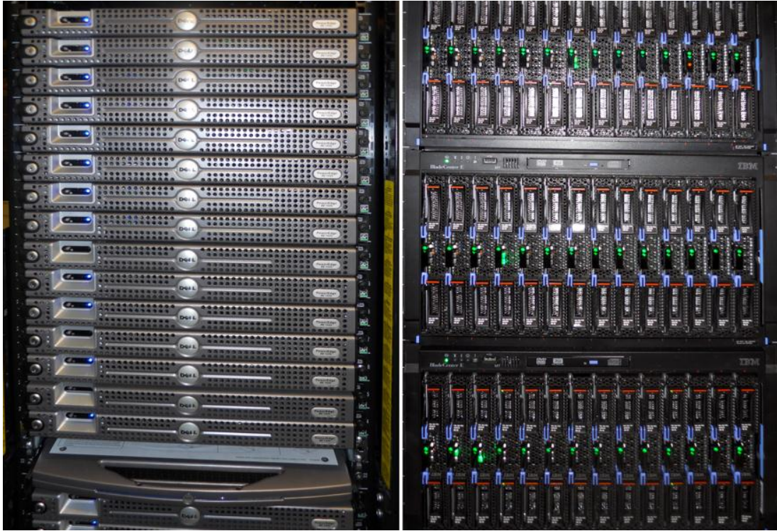
Figura 3.1 – Frontal dels dos tipus de servidors, pizza (esquerra) i blades (dreta). Podem veure la major densitat de nodes del tipus blade.
