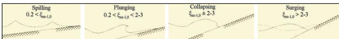
Figura 15. Tipos de rotura según el número de Iribarren [22].
