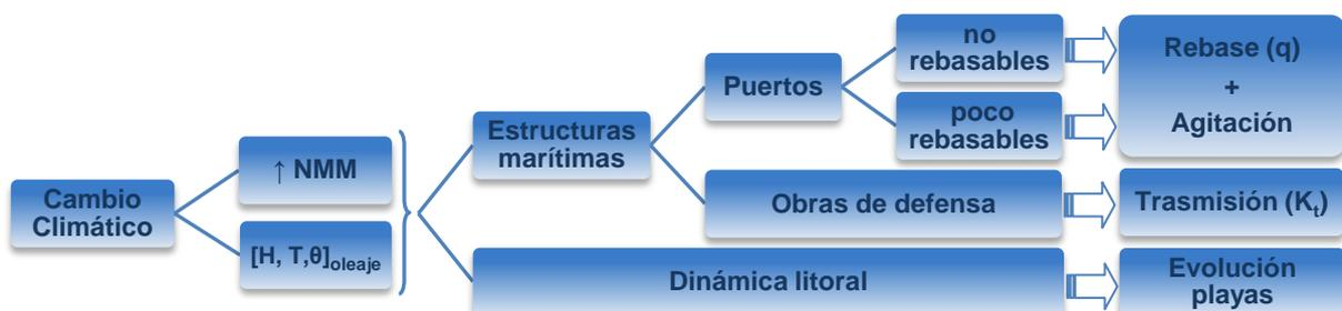
Figura 17. Esquema de las posibles afecciones en la ingeniería marítima como consecuencia del cambio climático y sus correspondientes parámetros de estudio (fuente propia).
