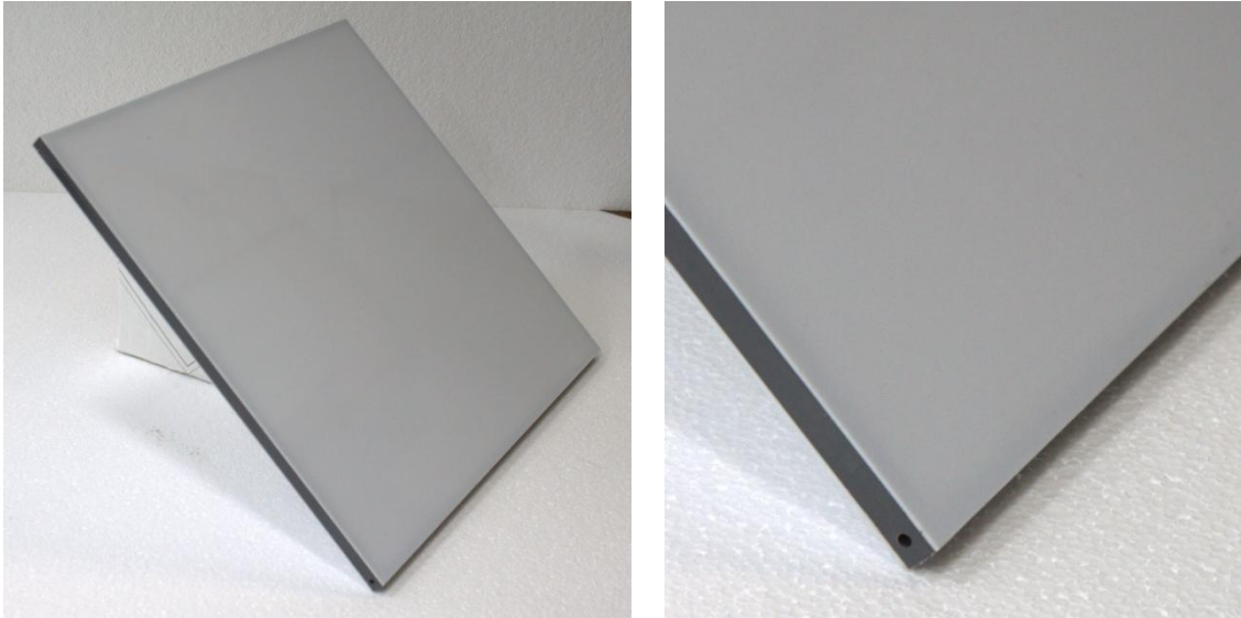
Figura 27. Primera comporta de pòrex (esquerra) i detall del llom a la zona d'ancoratge (dreta)
