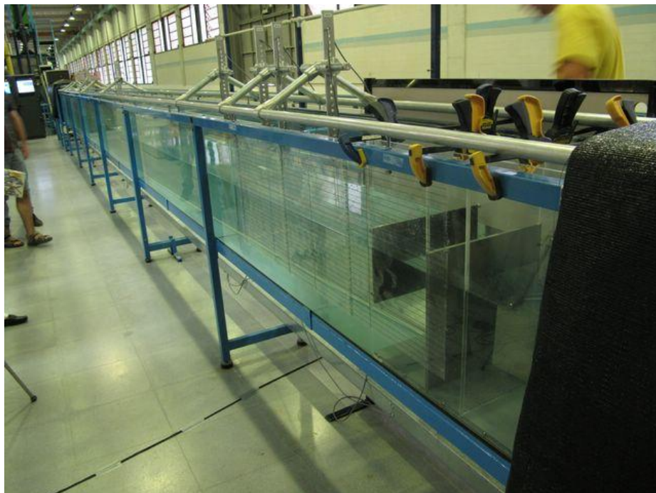
Figura 17. Canal de simulació d'onatge regular CIEMito
