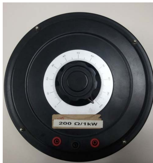
Figura 5.2.2 Carga para las pruebas de la implementación de la fase.
