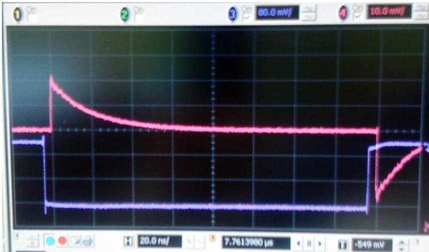
Fig. 3.14: Señal de entrada después del FPA.
