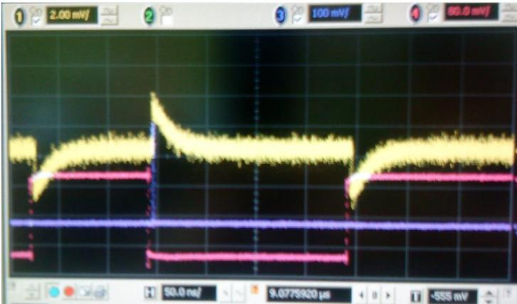
Fig. 3.9: Captura del osciloscopio de la señal de entrada después del FPA y con la realimentación apagada
