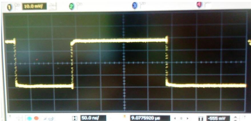
Fig. 3.12: Medida directa con el osciloscopio de la señal que entramos al circuito.
