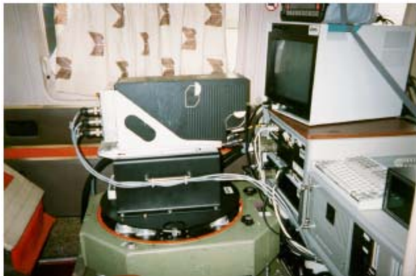
Sistema CASI-ICC, receptor GPS i INS en l'avió Partenavia P-68 Observer de l'Institut Cartogràfic de Catalunya.
