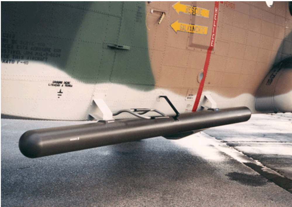
Antena d'un SLAR Ericsson muntat en el fuselatge d'un avió
