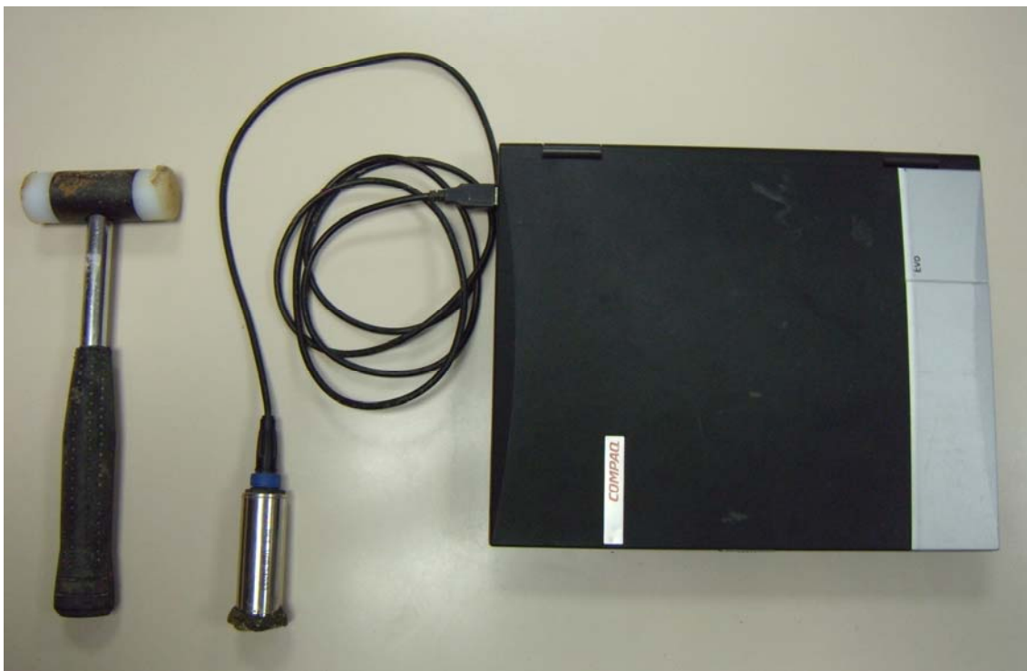
Figura 2.1: Equipo para el ensayo mediante el método sónico. Martillo, acelerómetro y ordenador.
