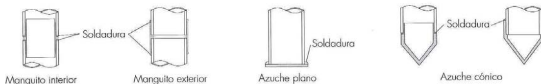
Figura 1.5: Azuches y manguitos de unión para pilotes metálicos tubulares
