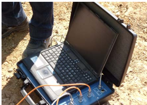
Figura 2.7: Equipo de registro de datos para el método ultrasónico Cross-Hole.
