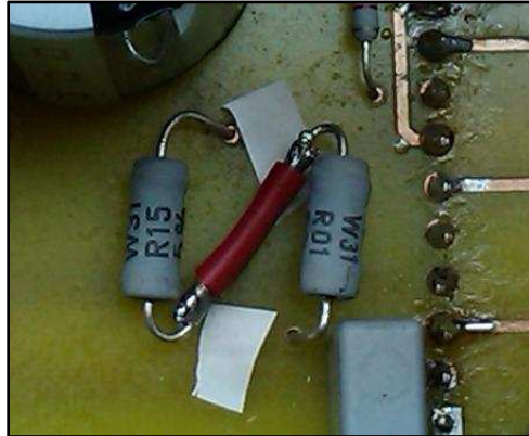
Figura 26: Correcció del muntatge dels resistors de sensat de corrent
