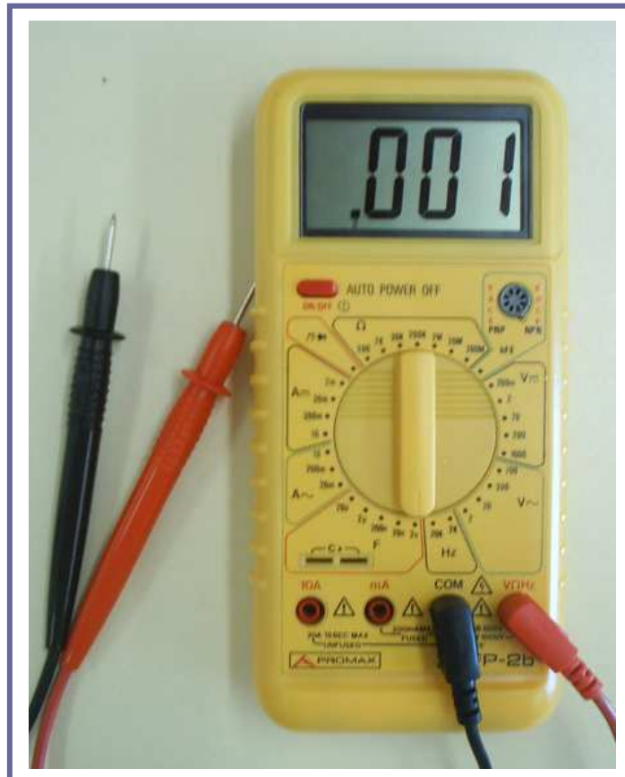
Fotografia 8.11 Fotografia del amperímetre de la empresa PROMAX. Ha estat aquest l'amperímetre utilitzat en l'execució de les diferents proves de revisions verificacions, en el projecte
