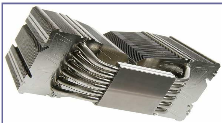
Fotografia 5.18 Part inferior sistema "Heat-Pipes" de refrigeració. Podem observar com en la part inferior els tubs "Heat-Pipes" conflueixen en un mateix punt per tal d'absorbir la temperatura generada per la Peltier. Aquesta temperatura serà transportada cap als radiadors i dissipada en les aletes del radiador. [21]
