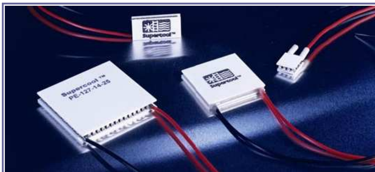
Fotografia 3.11 Qualitats de Cel·les Peltier. Observem com les dues Cel·les Peltier del primer pla tenen visualment qualitats diferents, observant- si com en una s'observen les terminacions interiors i en l'altre aquestes terminacions han estat tapades per evitar contacte amb l'exterior. [25]
