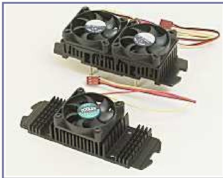
Fotografia 5.19 Diferents muntatges de radiadors amb ventiladors. En un muntatge observem un muntatge amb dos ventiladors en l'altre observem solament un ventilador. [21]
