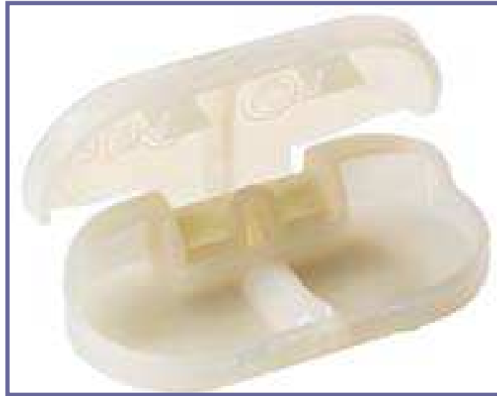
Fotografia 8.6 Fotografia de impressió amb material DurusWhite - FullCure430. Observem la seva menor translucitat, així com l'espessor amb la que s'ha realitzat la impressió. Es pot veure com es tracta de un ensamblatge de dues peces format entre elles una bisagra. [1]
