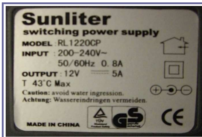
Fotografia 5.30 Fotografia on observem les característiques del transformador elèctric. Aquestes característiques queden mostrades en el revers del propi transformador mitjançant un adhesiu plàstic.
