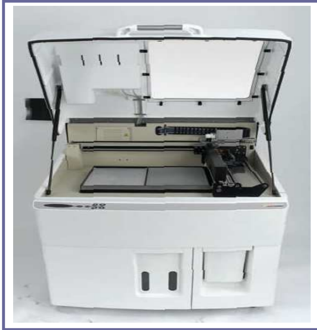
Fotografia 8.3 Fotografia de la màquina d'estelitografia amb la comporta oberta. Podem observar com a l'interior es poden veure el rodet d'estelitografiar i els dos dipòsits quadrats on s'emmagatzema el conglomerat d'estelitografiar. A la part exterior a l'inferior de l'aparell hi ha un dipòsit amb un líquid conglomerant.
