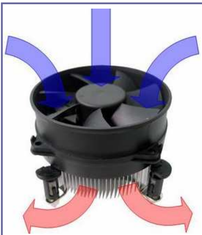
Figura 5.5 Figura del moviment de dissipació de la calor per convecció forçada en un ventilador. Podem observar un muntatge treballant en conjunt entre un ventilador i un radiador, el moviment de l'aire que entra a una temperatura baixa i surt escalfat a una temperatura més alta. [21]
