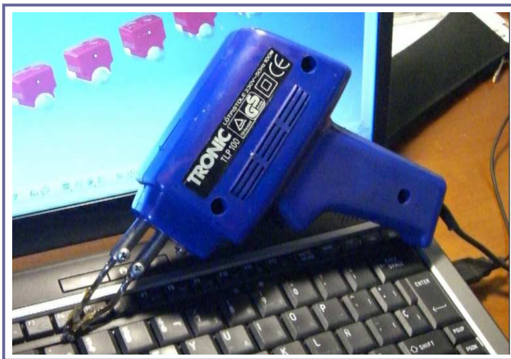
Fotografia 8.12 Fotografia del soldador utilitzat en el projecte. Observem com aquest soldador no treballa continuadament sinó que solament calenta quant es pitja un botó amb el que es minimitza el consum elèctric.
