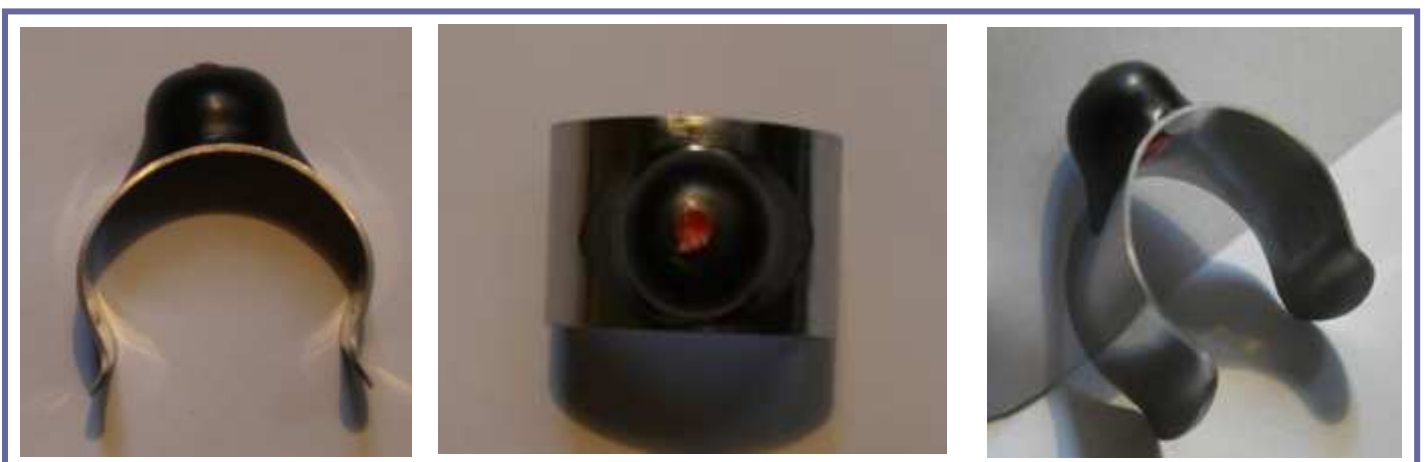
Fotografia 5.17 Conjunt de fotografies de la peça en la que s'ha basat el disseny de subjecció del sòcol-xeringa.
