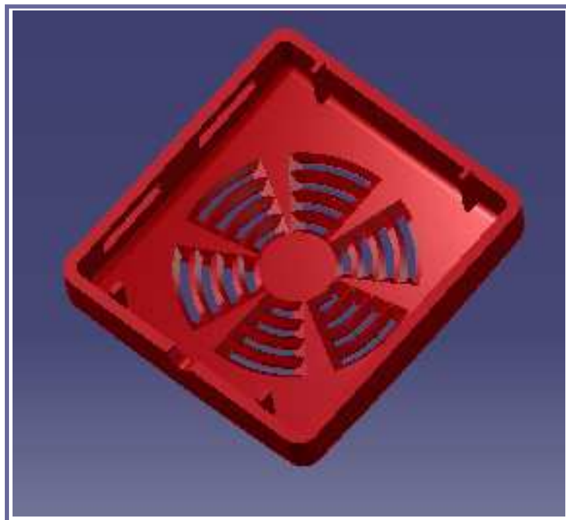
Figura 5.22 Interior tapa superior. Observem els quatre nervis que a més de rigidificar la peça fan d'ajuda per el muntatge.
