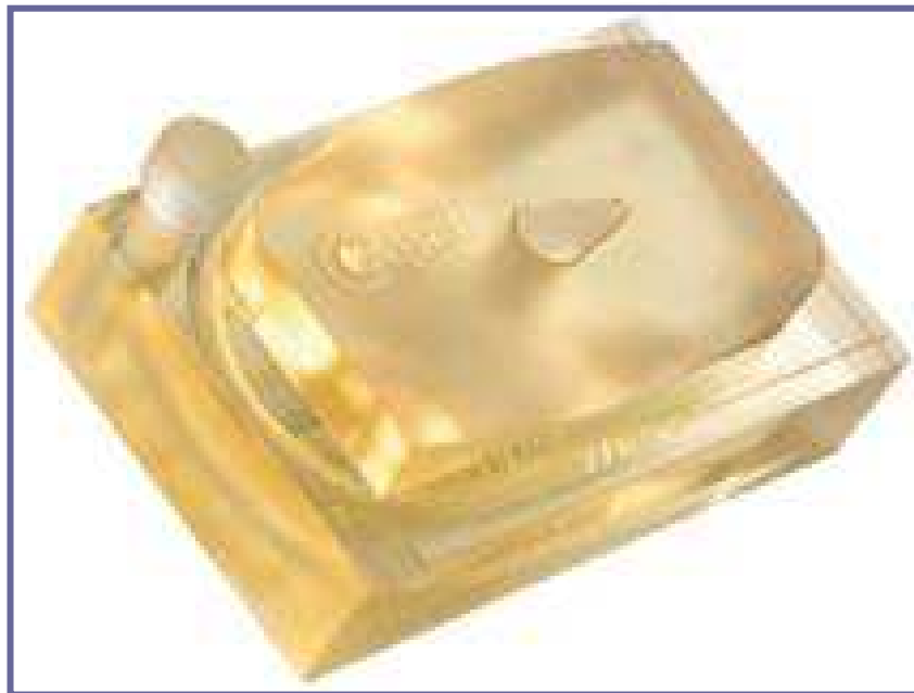
Fotografia 8.5 Fotografia d'una peça impresa amb material FullCure720. Observem la seva translucitat i el seu color groguenc.
