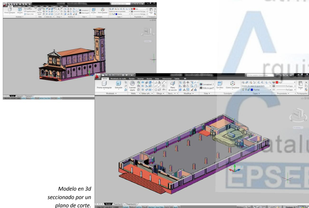
Modelo en 3d seccionado por un plano de corte.
