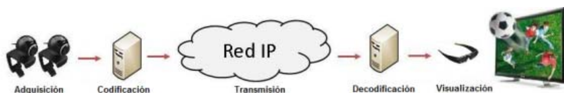
Fig. 0.1 Escenario completo de transmisión de vídeo con codificación MVC.
