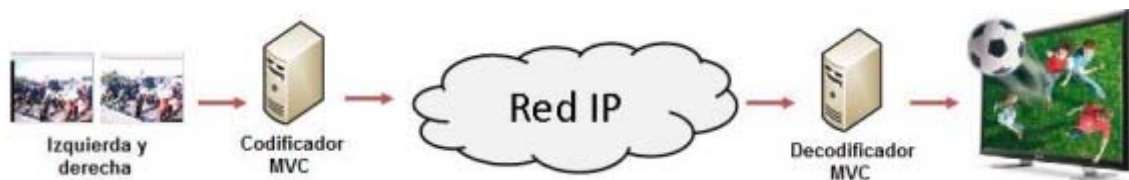
Fig. 4.24 Transmisión de vídeo mediante codificación MVC.
