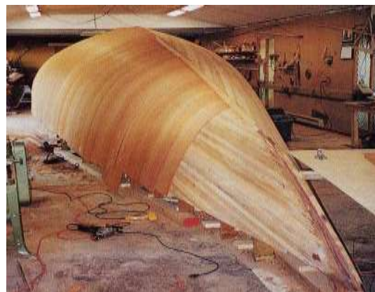
Img. 15, Doble forro
