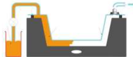
Img. 33, Fase de inyección de la resina
