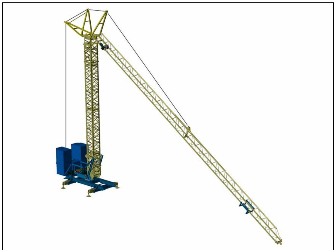
Figura 8.9. Mástil en posición vertical (Nótese que la punta de la pluma se ha alejado)
