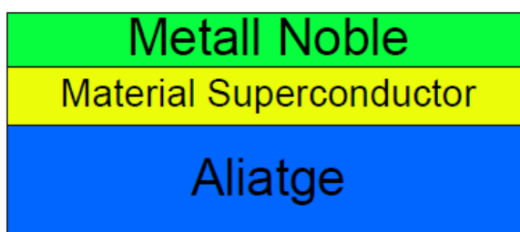
Figura 1.7: Cinta superconductora Tipus 2G.
