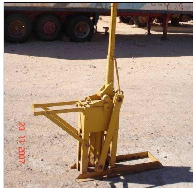
Fotografia 34: Màquina de producció d'atovons
