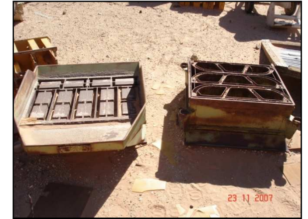
Fotografia 38: Mòlles per confeccionar blocs de formigó i cassetons de formigó
