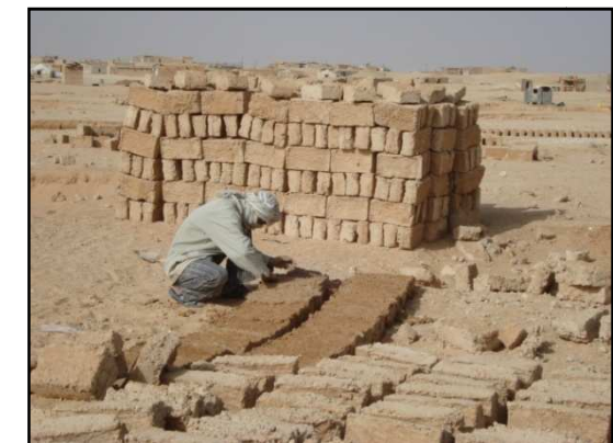
Fotografia 32: Operari girant i copiant els atovons
