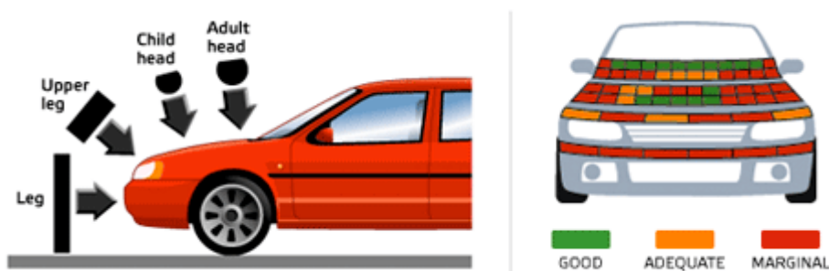
Figura 59: Protección de peatones
