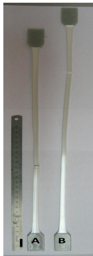
Figure 6.3.2.2: Curvas típicas de tracción de las probetas de R-PET/LDPE/GMA sin o con tratamiento térmico y las fotos de las probetas de tracción sin (A) y con (B) tratamiento térmico después el ensayos a una velocidad de 1mm/min.
