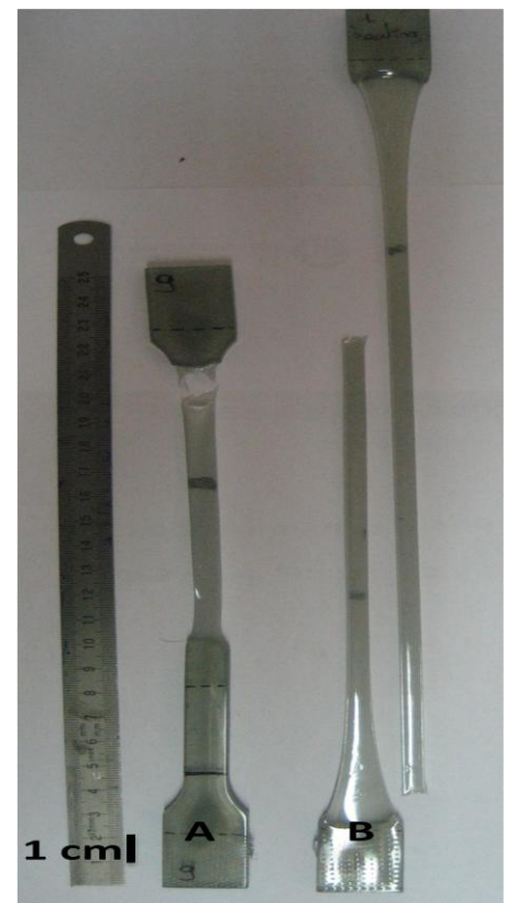
Figure 6.3.2.1: Curvas típicas de tracción de las probetas de R-PET sin o con tratamiento térmico y las fotos de las probetas de tracción sin (A) y (B) con tratamiento térmico después del ensayo a una velocidad de 1mm/min.
