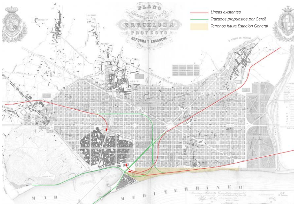
I.1-F.08 - Esquema ferroviario del Proyecto de Ensanche de 1859 de Ildefons Cerdà
