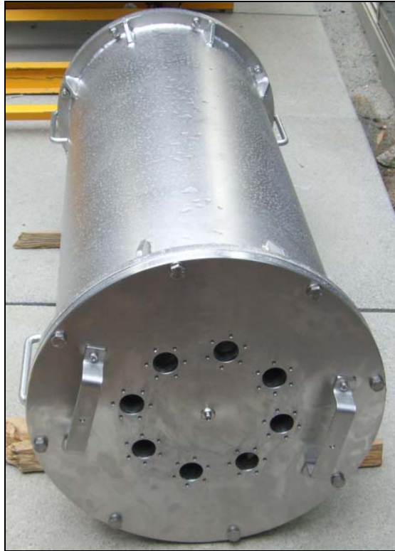
Figura 1.12: Cilindro que contiene la electrónica
