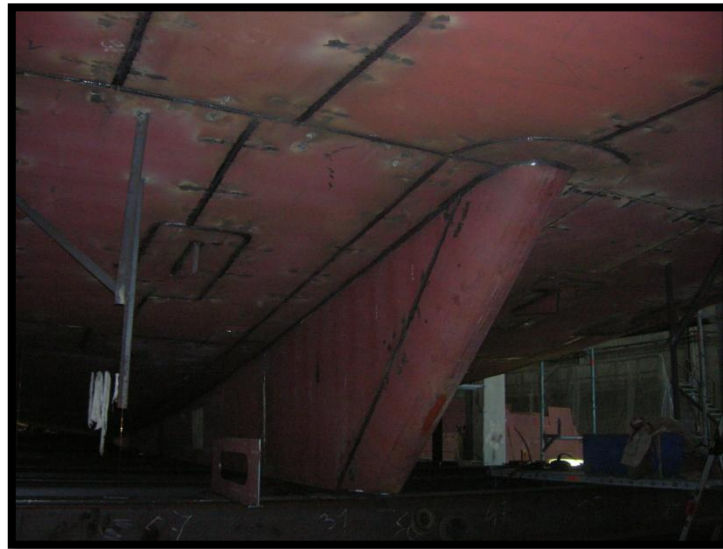
Imagen 10.2 Detalle unión quilla del buque
