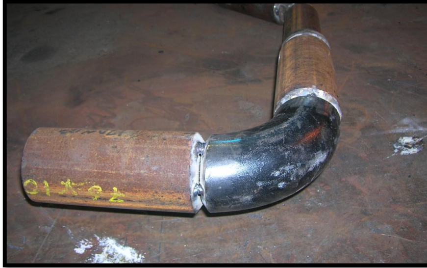
Imagen 10.5 Detalle unión tubos materiales disimilares
