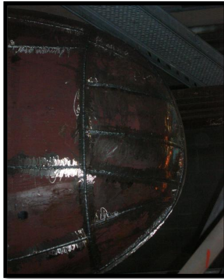
Imagen 10.4 Soldadura en bulbo del buque
