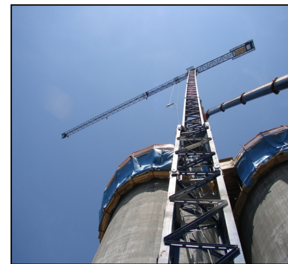
Imatges de la reparació de la grua torre
